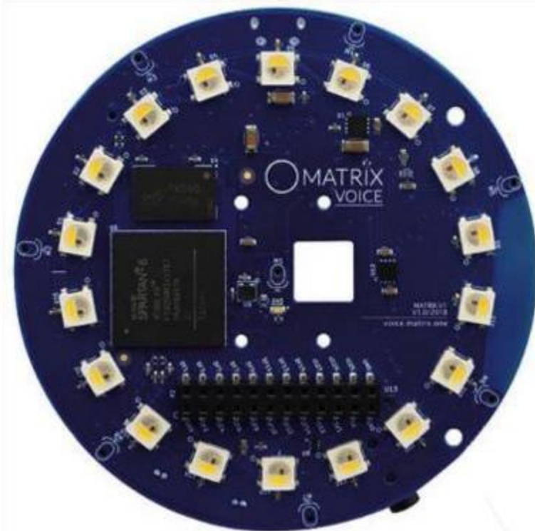
Das Board von Matrix Voice verfügt über acht Mikrofone und integrierte Signalverarbeitung – ideal für Sprachassistenten
