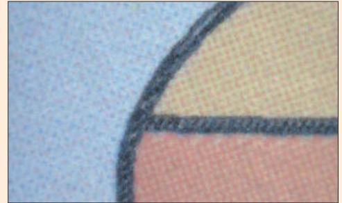
Brother DCP-9015CDW: im Schwarz-Weiss-Druck saubere Ränder und kräftiger Auftrag, keine Satellitenpixel; beim Farbdruck etwas blasser, aber genauer Farbauftrag
