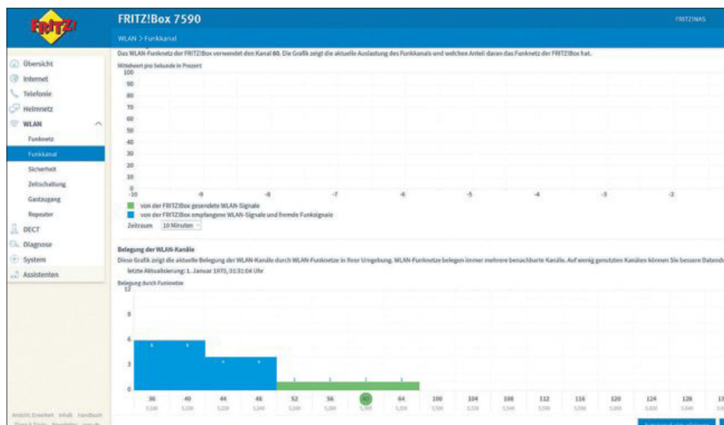
Bild 2: Die Wahl eines unbelasteten Funkkanals bringt mehr Stabilität und Bandbreite
