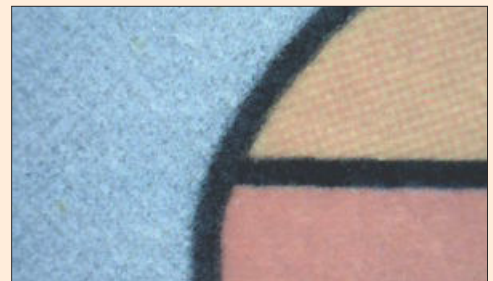
Lexmark CX417de: im Schwarz-Weiss-Druck kräftiger Auftrag, keine Falschpixel, Ränder leicht überzeichnet; im Farbdruck präziser, satter Farbauftrag ohne Ausfransen an schrägen, feinen Linien
