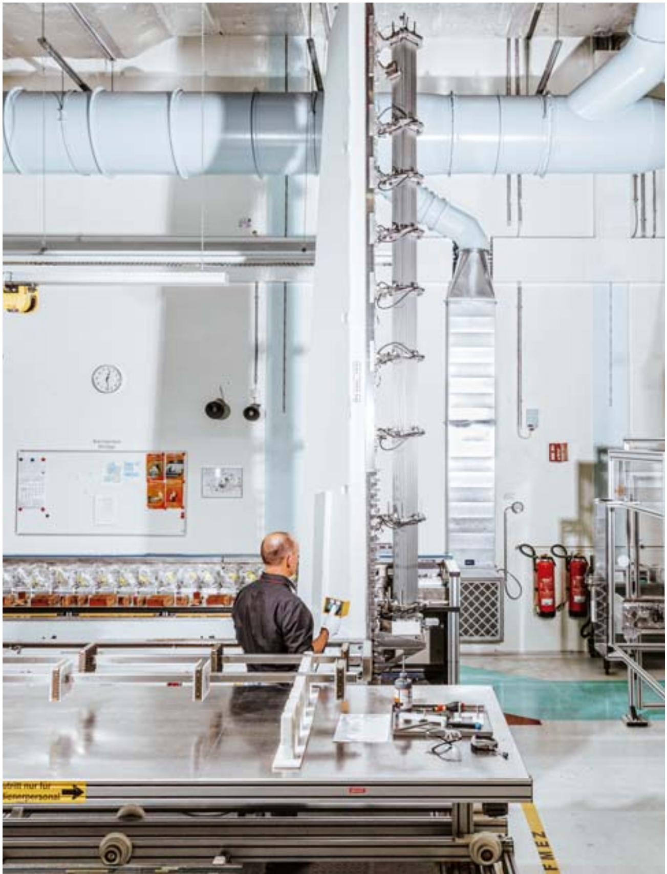
Strahlende Stäbe Fertiges Brennelement für einen Siedewasserreaktor
