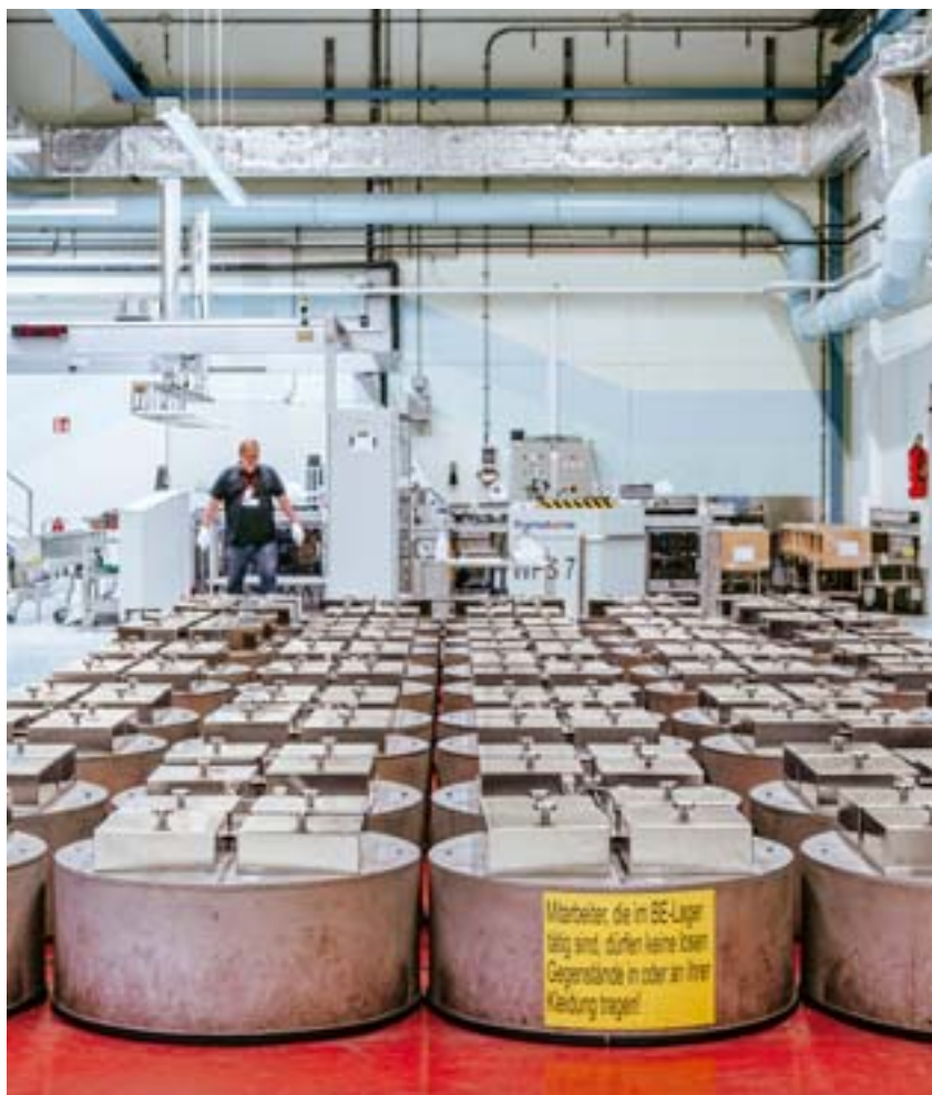
Tiefergelegt Brennelemente werden in Lingen unterirdisch bis zum Abtransport zum Kunden gelagert
