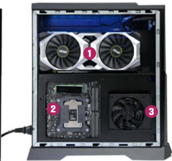
Das Kammer-Kühlsystem besteht aus drei Räumen für Grafikkarte, Mainboard und Netzteil mit separater Frischluftzufuhr: 1 Grafikkarte, 2 Mainboard inklusive SSD (verdeckt), CPU und DDR4-RAM, 3 Netzteil.
