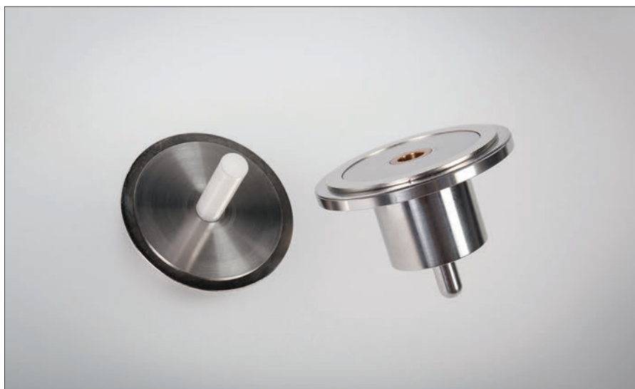
Das Lager des Plattentellers ist aufgebaut aus einem magnetischen Keramiksplint auf Zargenseite sowie einem gegenpoligen Edelstahlgehäuse mit einer Fassung in Sinterbronze
