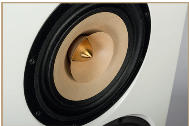
Der Mittelhochtöner mit Papiermembran besitzt einen Phase Plug aus Aluminium und einen Schwirrkonus
