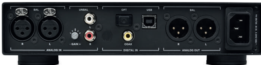
Neben einer Vielzahl an digitalen Anschlüssen findet sich auf der Rückseite auch ein Regler für die Vorverstärkung des unsymmetrischen Analog-Eingangs
