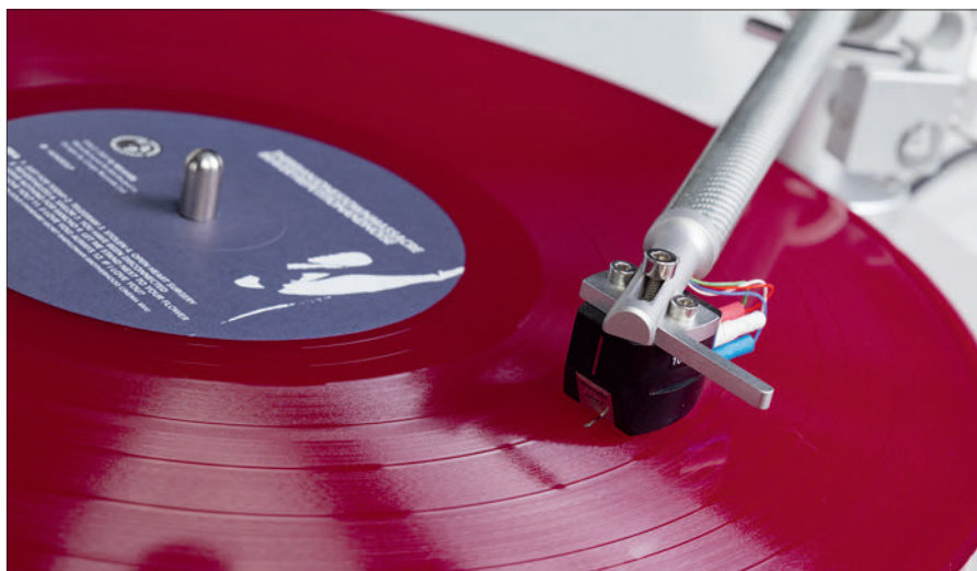
Als Abtastsystem diente in unsrem Test der Artist V2 Ebony. Entsprechend dem Namen besteht dessen Gehäuse aus resonanzarmem Ebenholz
