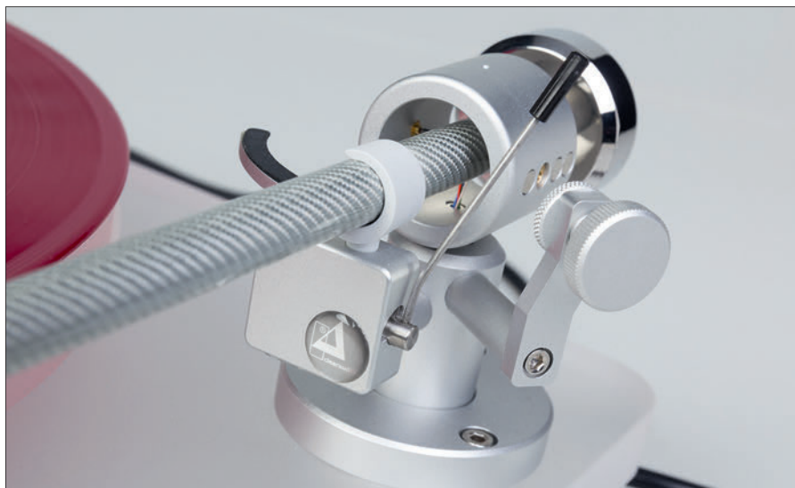
Der Antiskating-Mechanismus funktioniert mittels drei aneinandergereihten Magneten. Die Aluminiumschraube bestimmt dabei den Stärkegrad
