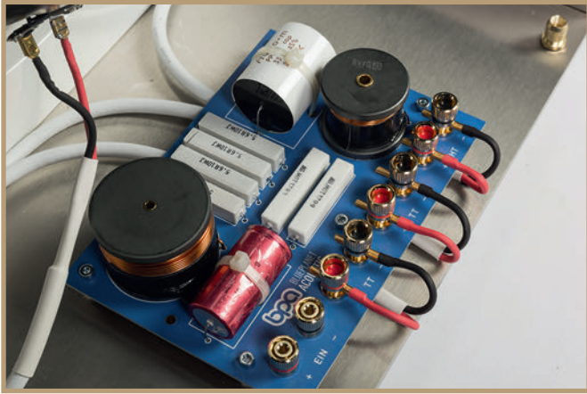
Die Frequenzweiche - im Original unter Plexiglas - ist ein mustergültiges Beispiel für sauberen Platinaufbau
