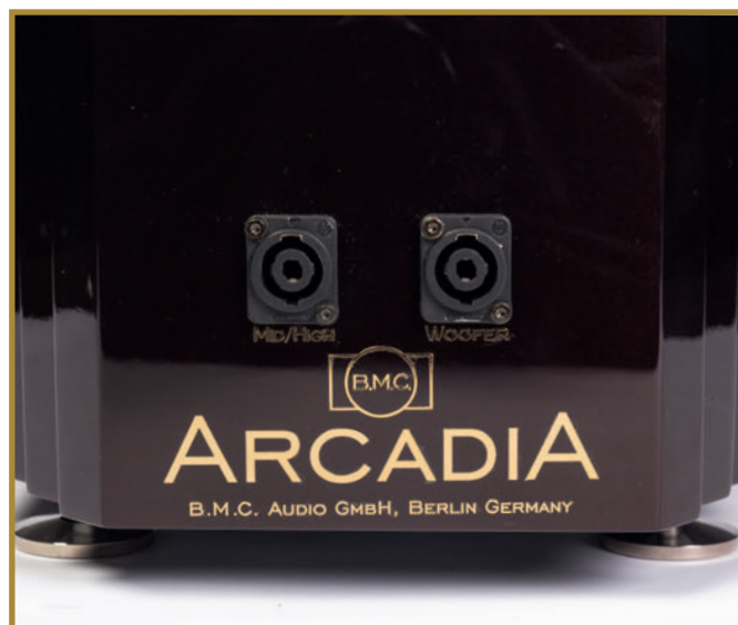
Der Lautsprecher wird über Speakon angeschlossen, dabei sind die drei Wege auf zwei Anschlüsse gelegt
