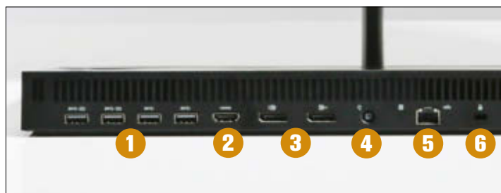
Der HP Elite One 1000 G1 hat reichlich Anschlüsse an seiner Rückseite: 4 x USB 3.0 (1), 1 x HDMI (2), 2 x Displayport (1 x Eingang, 1 x Ausgang) (3), Buchse für das externe Netzteil (4), Netzwerkbuchse (5) und eine Befestigung für Schlösser nach dem Kensington-Lock-Standard (6).
