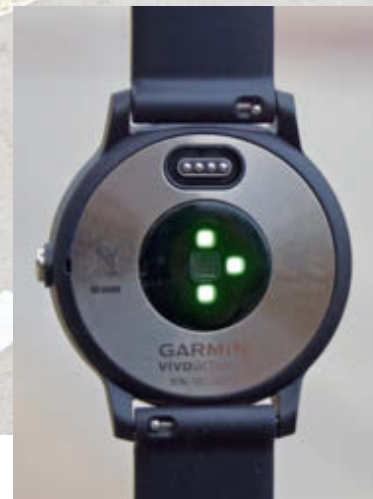
Alle drei Wearables messen den Puls mittels optischem Herzfrequenzsensor.
