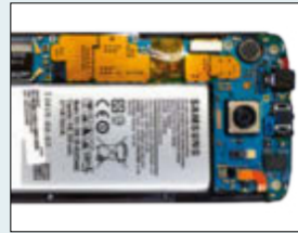
Im Labor wird die Geräte rückseite entfernt, um eine genaue Messung durchzuführen.
