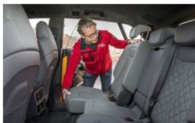
Die Fondbank lässt sich verschieben und in drei Teilen umklappen
