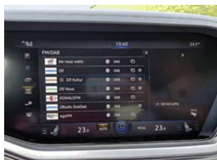
Bei schwachem Empfang wechseln UKW- und DAB-Tuner auf Web-Radio
