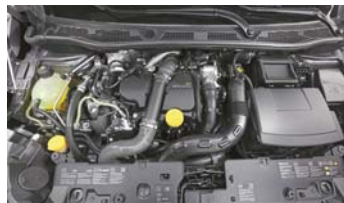
Ein Dreizylinder und drei Vierzylinder stehen zur Wahl, alle mit Turboaufladung und Abgasreinigung nach Euro 6
